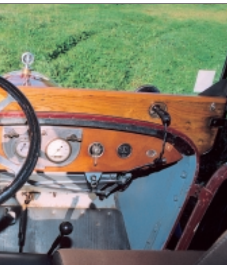
C'est au centre de la planche que sont regroupés le compteur, le compte-tours et, au centre, la prise qui permet de brancher un tuyau pour gonfler les pneus.
