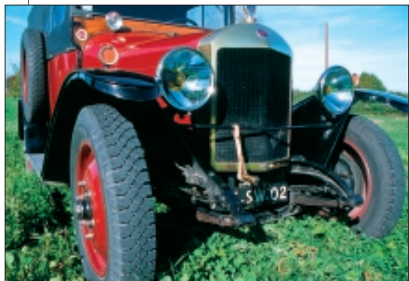
L'agressivité de l'AV avec, en prime, la manivelle maintenue en place par une sangle en cuir.
