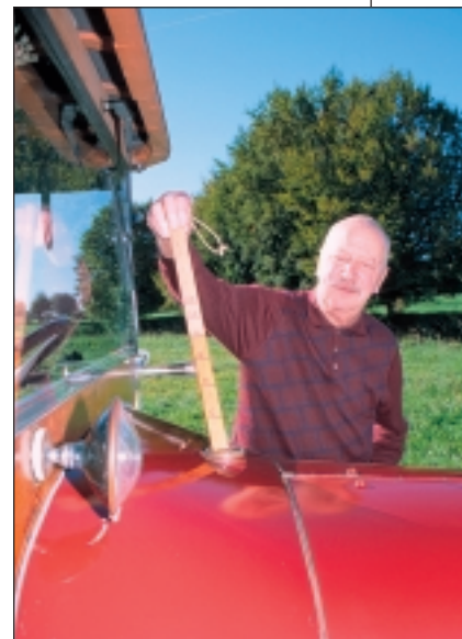
La jauge à essence ! Un simple morceau de bois gradué qu'il faut plonger dans le réservoir pour lire la quantité restante !
