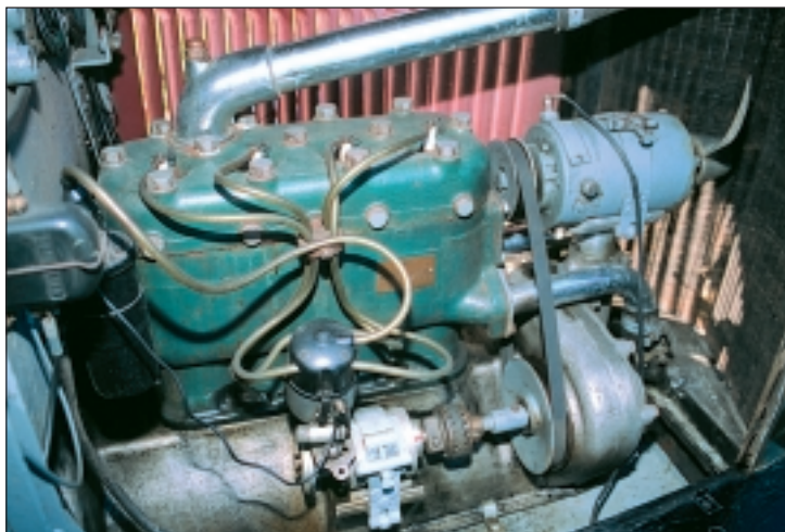
D'origine, c'est un carburateur Viel qui était monté sur cette Unic. Rolland lui a préféré le plus classique Solex.
