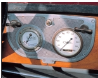
C'est au centre de la planche que sont regroupés le compteur, le compte-tours et, au centre, la prise qui permet de brancher un tuyau pour gonfler les pneus.
