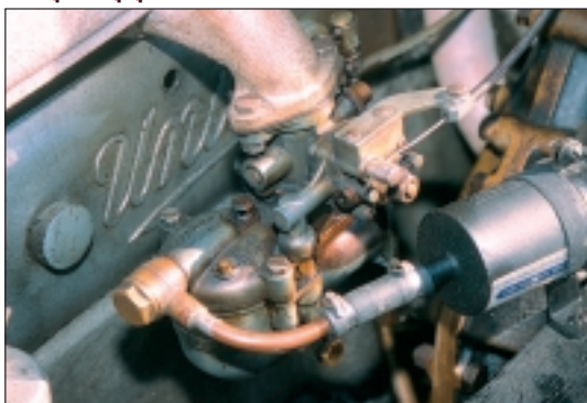
D'origine, c'est un carburateur Viel qui était monté sur cette Unic. Rolland lui a préféré le plus classique Solex.
