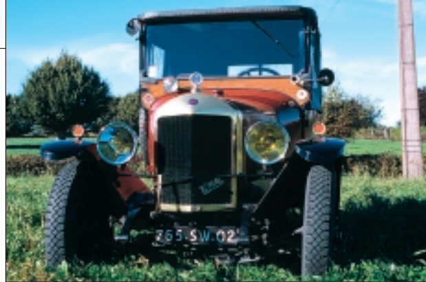
De face, l'Unic L2N boulangère présente deux belles gamelles à surface plate. Largement insuffisante pour voir les panneaux de signalisation de nuit. C'est pour cette raison qu'existe un phare Marchal de poursuite, actionnable de l'intérieur.
