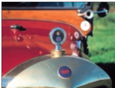
Au-dessus de la calandre et de son entourage en laiton, le bouchon de radiateur surmonté par un superbe thermomètre aux armes d'Unic.
